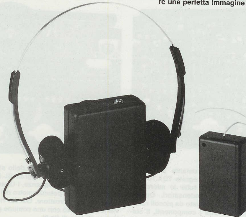
Fig.9 Il microtrasmettitore ed il ricevitore li potete utilizzare per controllare a distanza un piccolo che dorme nella culla o un anziano malato. Può servire anche per comunicare con chi è sul tetto di una casa per direzionare un'antenna oppure una parabola in modo da riuscire a ricevere una perfetta immagine TV.
