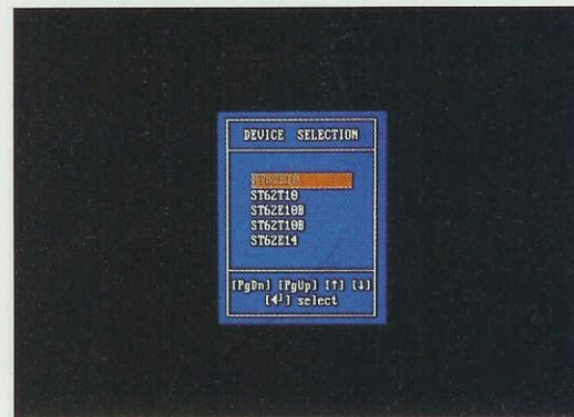
Fig.19 Sullo schermo apparirà una lista con tutti i tipi di ST6 che potete programmare e che sono circa 20. Per selezionare la sigla del vostro microprocessore usate i tasti freccia su e giù.
